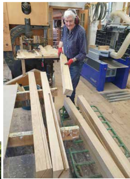
Nederst ligger råtræ i douglas klar til vingerne, og til højre fremstilles vindrosearmene. Vi glæder os til alt er på rette plads...
